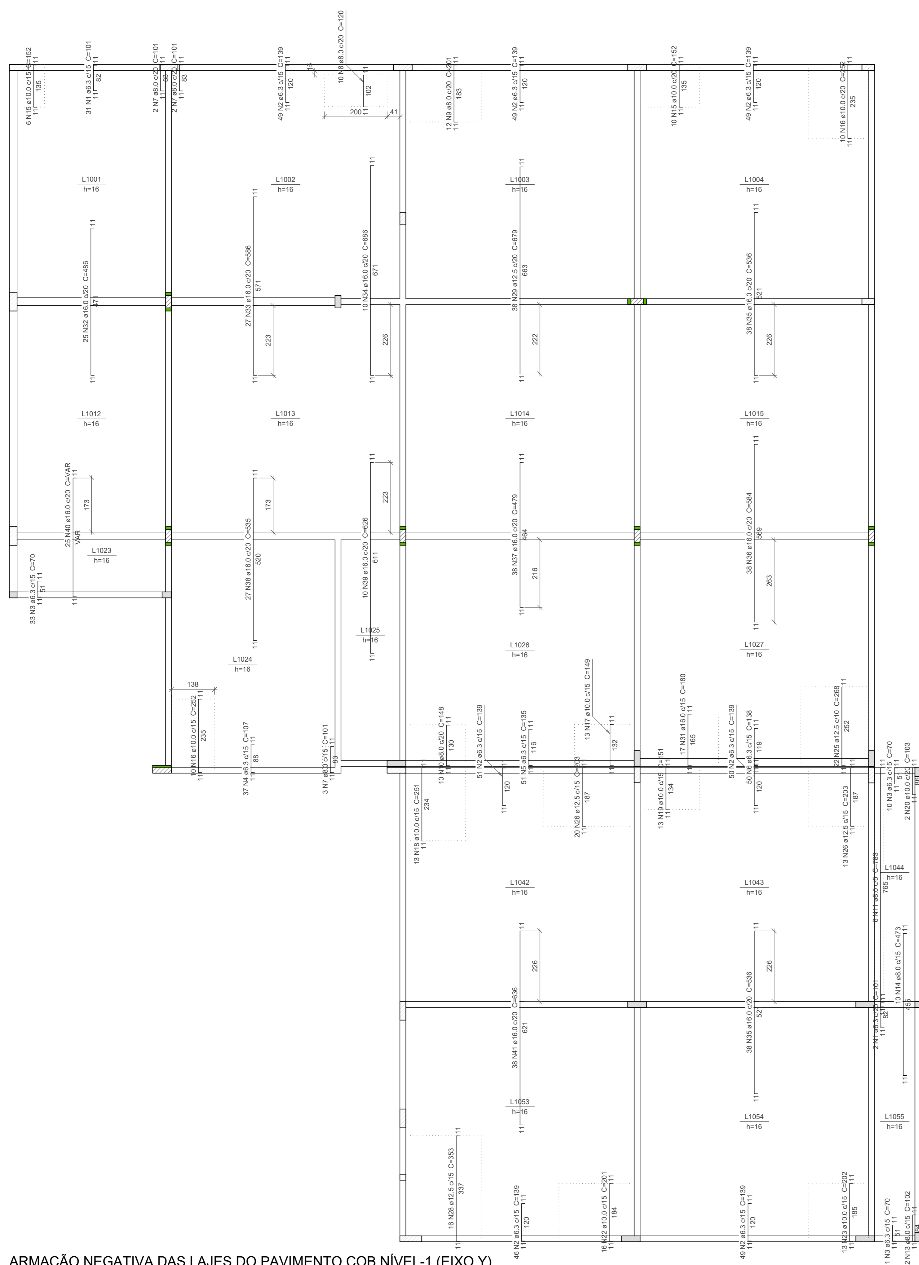
ARMAÇÃO NEGATIVA DAS LAJES DO PAVIMENTO COB.NÍVEL-1 (EIXO Y) ESCALA 1:75
