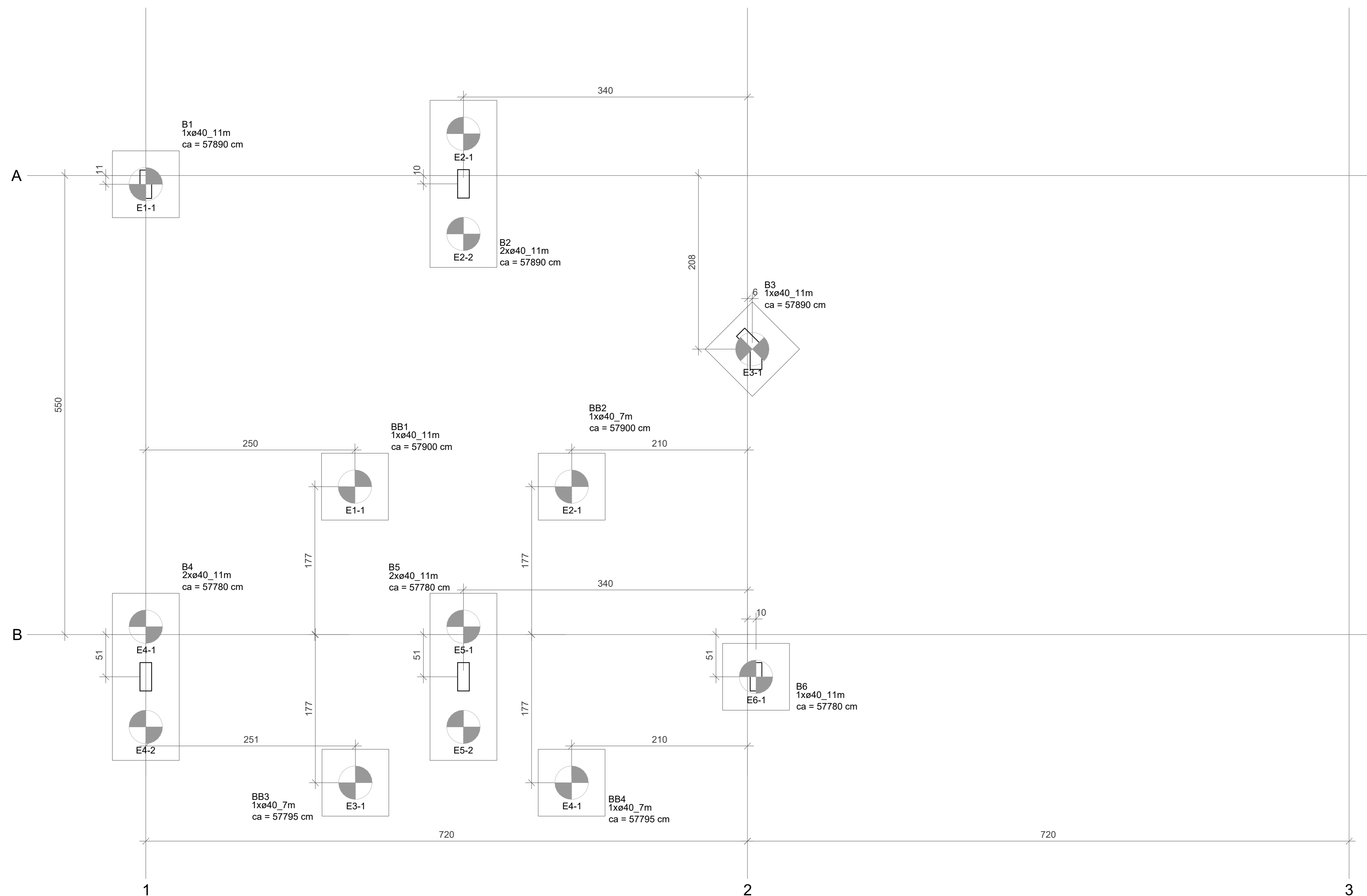
PLANTA DE LOCAÇÃO DAS ESTACAS ESCALA 1:25
